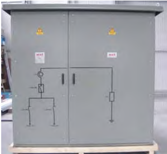
NOSPE-Widerstand im Stahlblechgehäuse 20kV, 2000A, 5s mit einem Leistungsschalter und zwei Trennschaltern mit Motorantrieben
