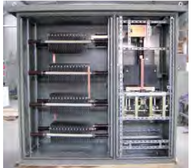
NOSPE-Widerstand im Stahlblechgehäuse 20kV, 2000A, 5s mit einem Leistungsschalter und zwei Trennschaltern mit Motorantrieben
