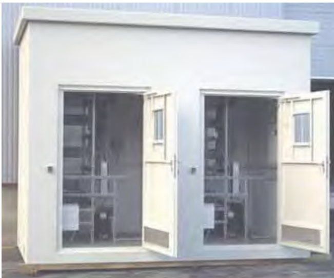
2 NOSPE-Widerstände in einer Betonstation 30kV, 2000A, 10s mit motorbetriebenen Lasttrennschaltern zur Sternpunktterdung an zwei Transformatoren
