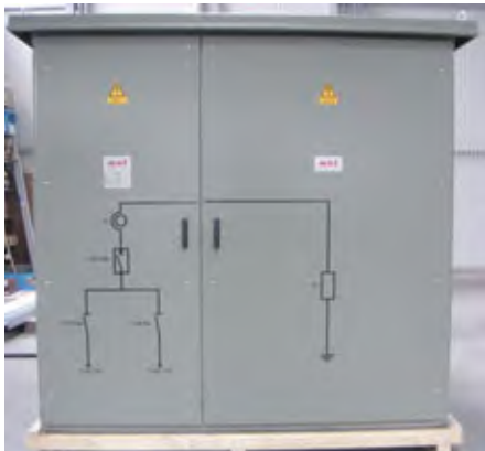
NOSPE-Widerstand im Stahlblechgehäuse 20kV, 2000A, 5s mit einem Leistungsschalter und zwei Trennschaltern mit Motorantrieben Earthing resistor in a sheet steel enclosure 20kV, 2000A, 5s with circuit breaker and two load break switches with motor drives
